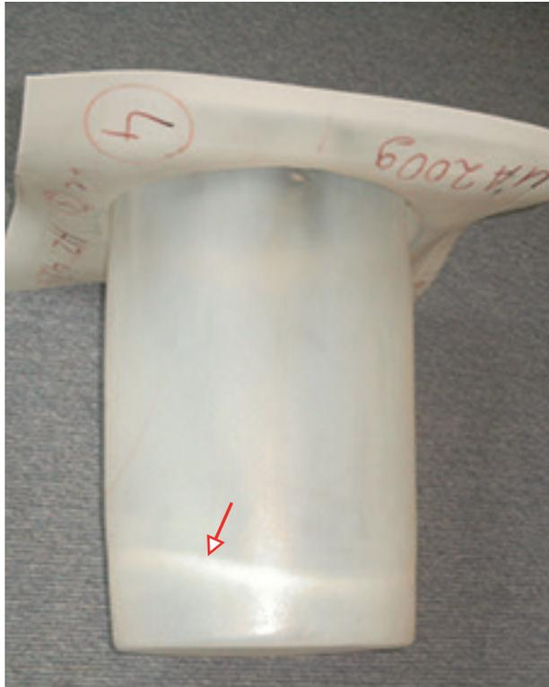
**Bild 2.17** Negativ geformtes Teil aus PEHD mit Schreckmarke verursacht durch den Vorstreckstempel
