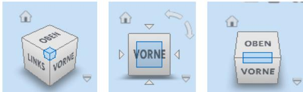
Mit dem kleinen Home-Button, dem kleinen Häuschen neben dem ViewCube, wird die Standardansicht aufgerufen, mit der das Bauteil gespeichert ist. Im Kontextmenü des ViewCube kann eine Ansicht als Ausgangsansicht festgelegt werden, die dann standardmäßig auf **VORNE** steht und damit auch die Standardansicht neu definiert.
