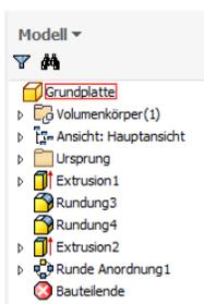
Der Strukturbaum zeigt immer den vollständigen Objektaufbau an. Dieses kann ein Bauteil, aber auch eine Baugruppe mit zugeordneten Bauteilen sein. Abgebildet wird die gesamte Erstellungshistorie. Der Aufbau ähnelt der Explorer-Funktion von Windows. Die Symbole vor den Einträgen lassen sich anwählen und damit klappt der Baum weiter auf.
